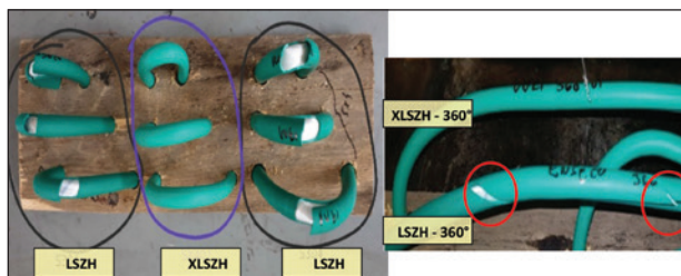
Obr. 2: Pohľad na výsledky testov vzoriek káblov s plášťom z termoplastického LSZH a silánom sieťovateľného XLSZH
